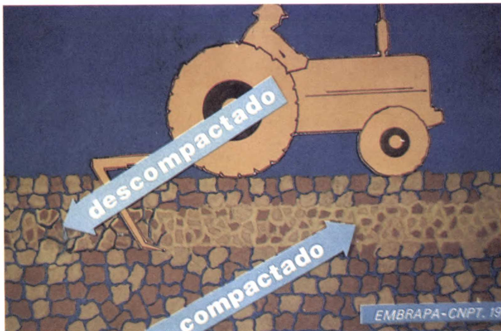
Fig. 9 - Descompactação do solo.
