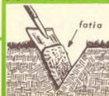
**2** Corte uma fatia de terra de cima a baixo numa das paredes da cova, com 3 a 4 centímetros de grossura.
